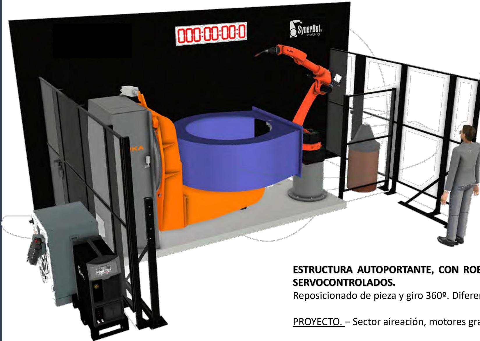
**ESTRUCTURA AUTOORTANTE, CON ROBOT, Y UNA MESA BASCULANTE DE 2 EJES SERVOCONTROLADOS.**
