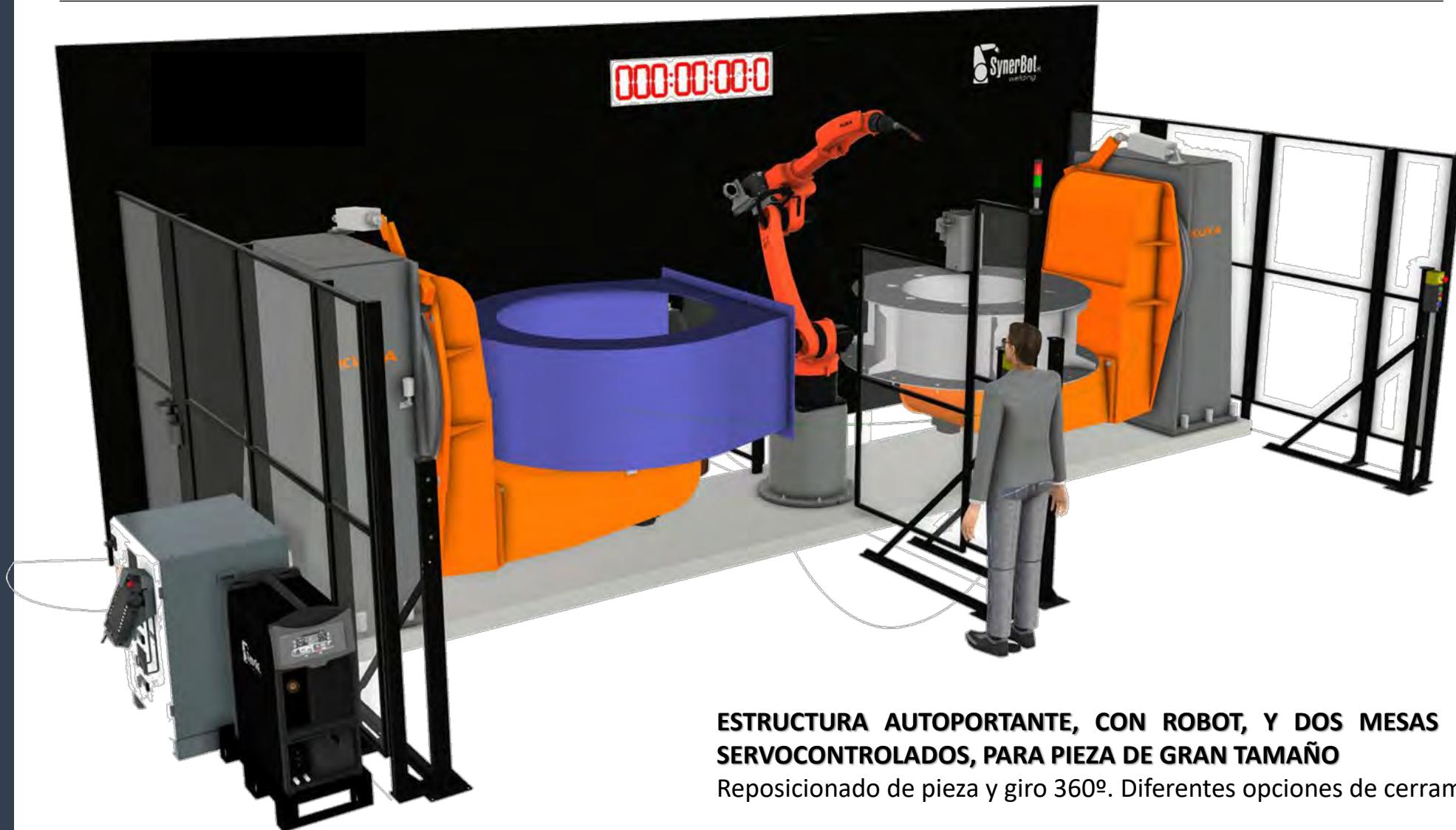
**ESTRUCTURA AUTOPORTANTE, CON ROBOT, Y DOS MESAS BASCULANTES DE 2 EJES SERVOCONTROLADOS, PARA PIEZA DE GRAN TAMAÑO**
