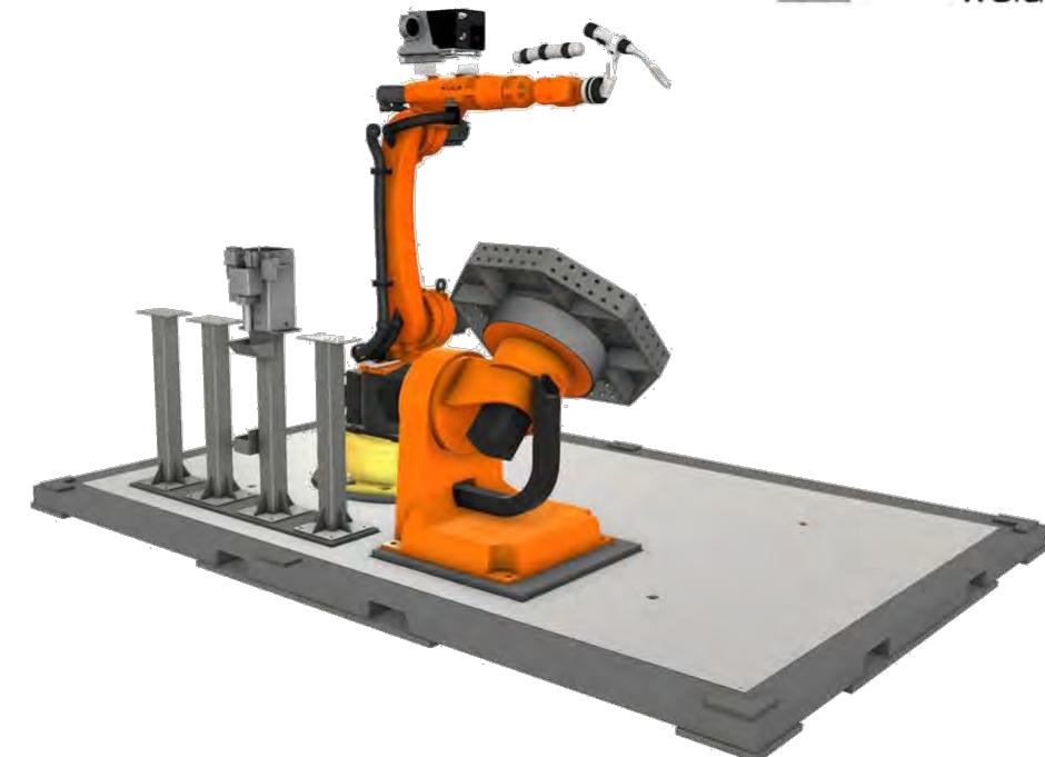
**ESTRUCTURA AUTOORTANTE, CON ROBOT, MESA 2 EJES SERVOCONTROLADOS, Y UNIDAD DE LIMPIEZA.**
