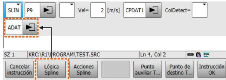
Fig. 20-15: Lógica SPLINE en el formulario inline
