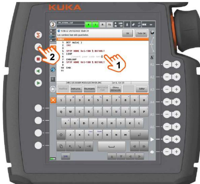
**Fig. 22-5: Programar LOOP-ENDLOOP, paso 5**
