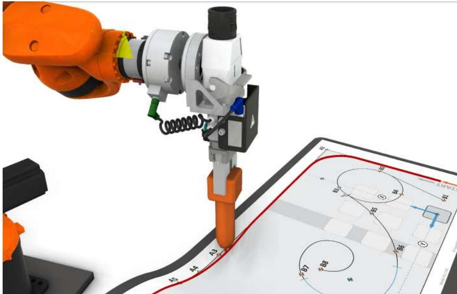
**Fig. 9-2: Aplicación de pegamento con errores**
