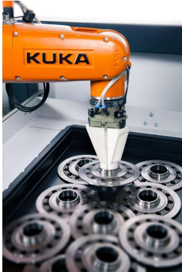
En su empresa hay una célula de robot para el procesamiento de componentes. Los componentes se extraen de un cargador o una caja de almacenamiento. A continuación, los componentes se procesan y se depositan. La reserva de piezas debe rellenarse manualmente.
