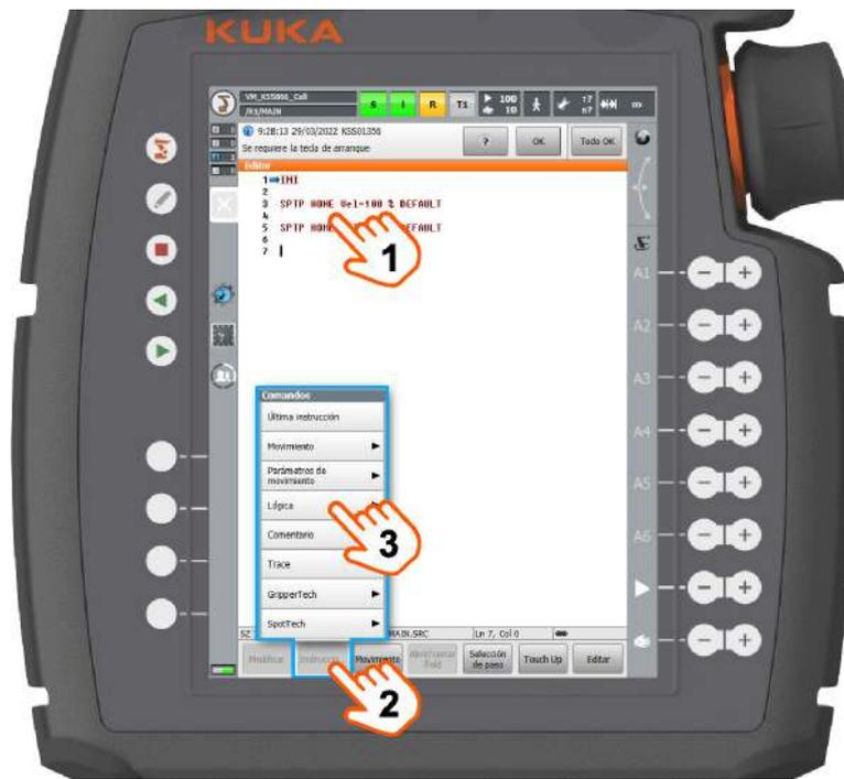
**Fig. 22-2: Programar LOOP-ENDLOOP, paso 2**
