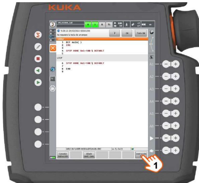
**Fig. 22-4: Programar LOOP-ENDLOOP, paso 4**
