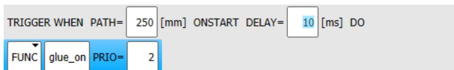
**Fig. 20-22: Ejemplo de Interrupt**
