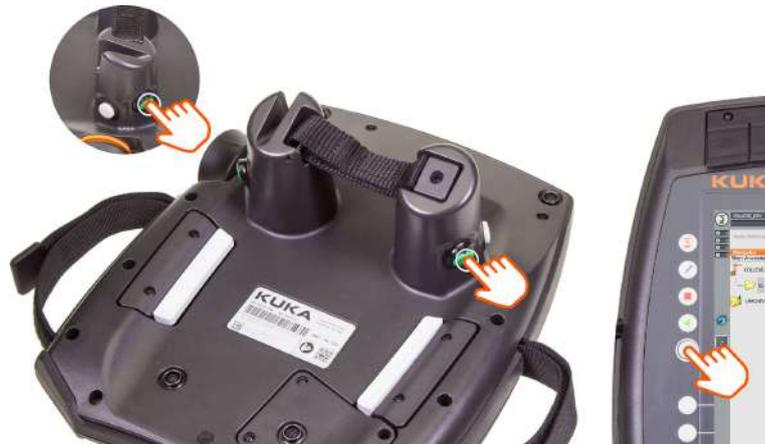
**Fig. 11-25: Posición de las teclas de arranque en el smartPAD**
