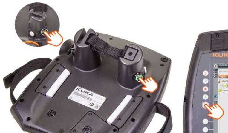
Fig. 11-39: Posición de las teclas de arranque en el smartPAD
