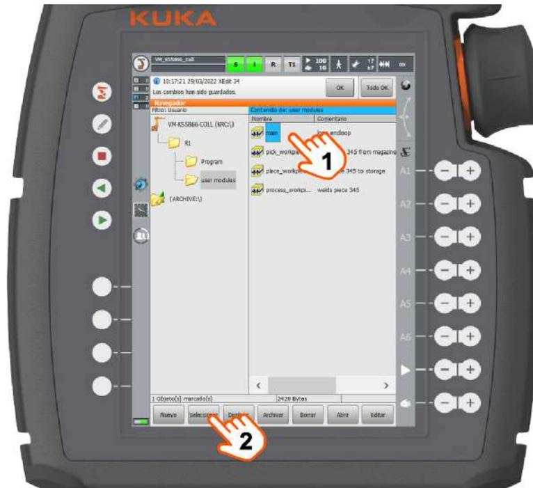
Fig. 22-8: Programar LOOP-ENDLOOP, paso 8
