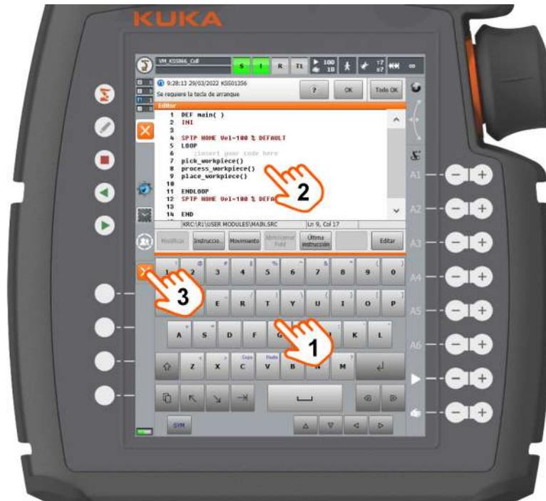
**Fig. 22-6: Programar LOOP-ENDLOOP, paso 6**
