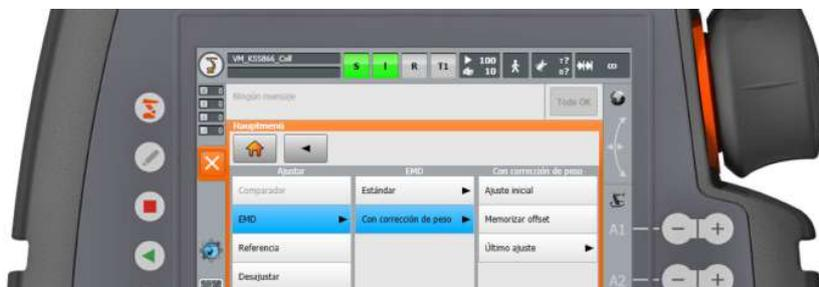
**Ruta de menú:** Tecla de robot > Ajuste > EMD > Con corrección de carga > Ajuste de carga > Primer ajuste
