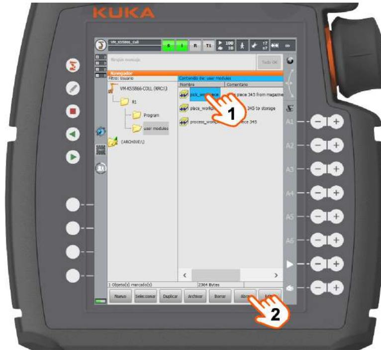
**Fig. 22-1: Programar LOOP-ENDLOOP, paso 1**
