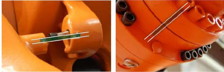
**Fig. 11-22: Ejemplos de posición de preajuste**
