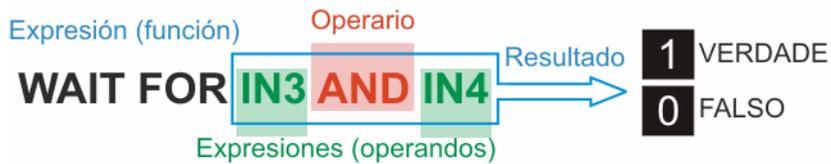
**Fig. 20-10: Ejemplo y principio de una combinación lógica**
