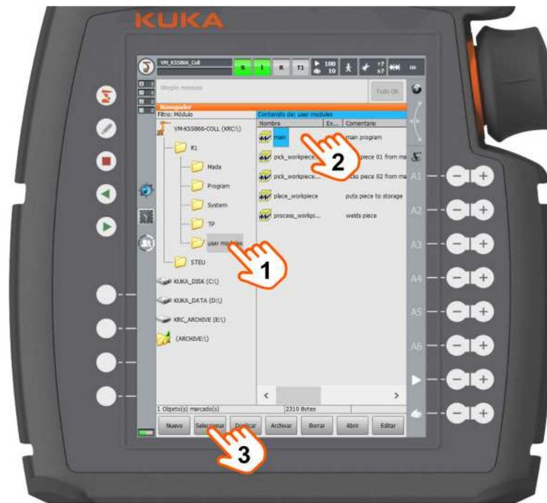
Fig. 4-4: Seleccionar un módulo
