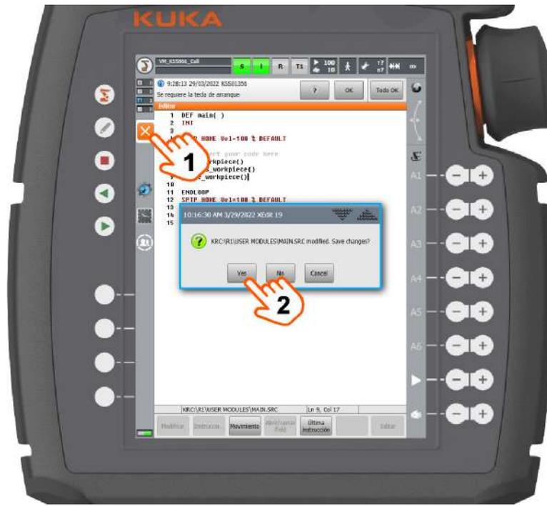
Fig. 22-7: Programar LOOP-ENDLOOP, paso 7
