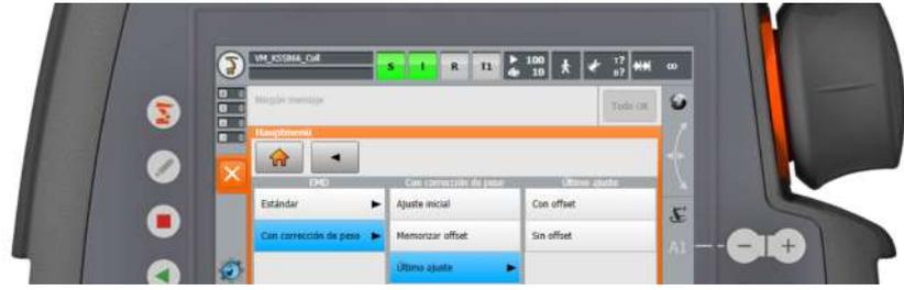
**Ruta de menú:** Tecla de robot > Ajuste > EMD > Con corrección de carga > Ajuste de carga > Con offset
