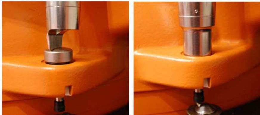
**Fig. 11-36: SEMD, enroscado sobre el cartucho de medición**
