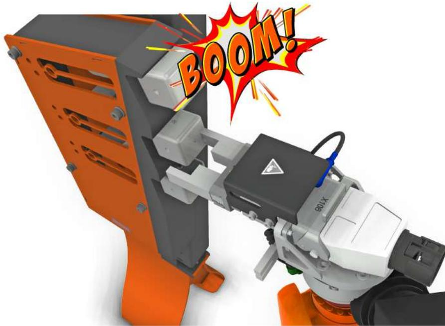
Fig. 11-2: Colisión en el cargador de clavijas
